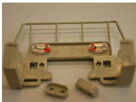
Les feux d'origine sont formés d'un bloc optique maintenu par une sorte de capsule clipsée, Déposer les deux capsules,
