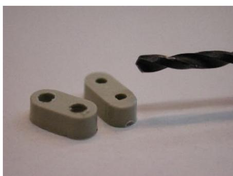
Les blocs optiques restés en place ont des queues cylindriques qu'il faut supprimer, Il convient ensuite d'agrandir les perçages des capsules à un diamètre de 2 mm,
