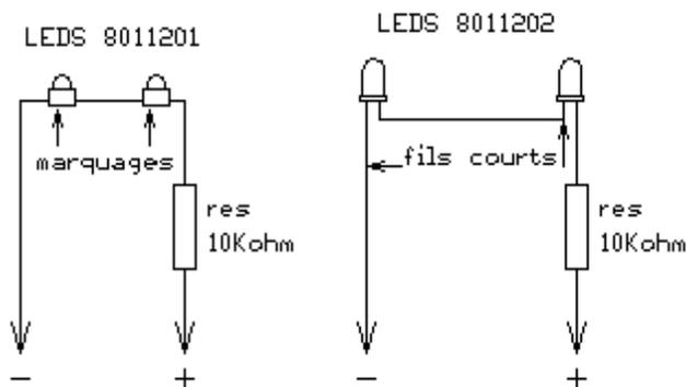
Veiller à respecter la polarité lors du raccordement des leds rouges de fin de convoi, sur la réglette, les pôles plus et moins sont sur les deux bandes externes qui parcourent toute la longueur de la réglette. Le pôle moins de la réglette, est relié au pôle moins du condensateur, placé en bout de réglette.
