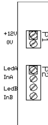
Les bornes 0V et +12V doivent être reliés à l'alimentation utilisée pour les modules 12001,
