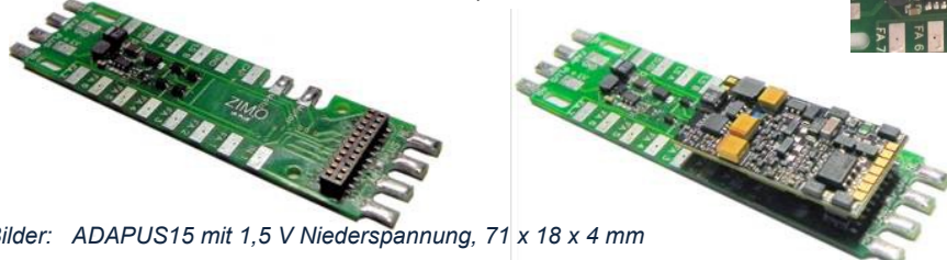
ADAPUS15 mit ZIMO Sound-Decoder MX645P22, 71 x 18 x 7,8 mm
