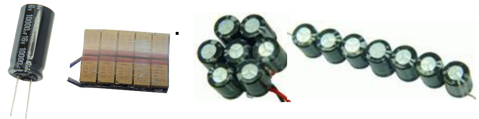
Elko Tantal-Paket 5000 µF Goldcap-Module mit 7 Goldcaps (7 x 1F in Serie, also 140000 F - 17,5 V)
