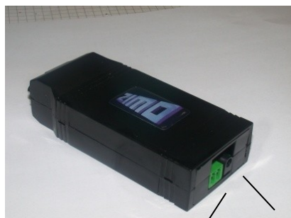
connecteur voie de mise à jour leds connecteur alimentation
