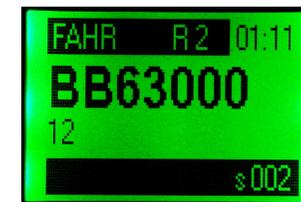
Après 2 secondes ou plus rapidement si une touche est pressée, affichage du mode correspondant: CONDUITE ou AIGUILLAGE (selon le dernier mode utilisé), ou en cas de première utilisation:
